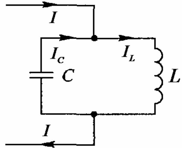
Схема нагревающего контура индукционной цепи
