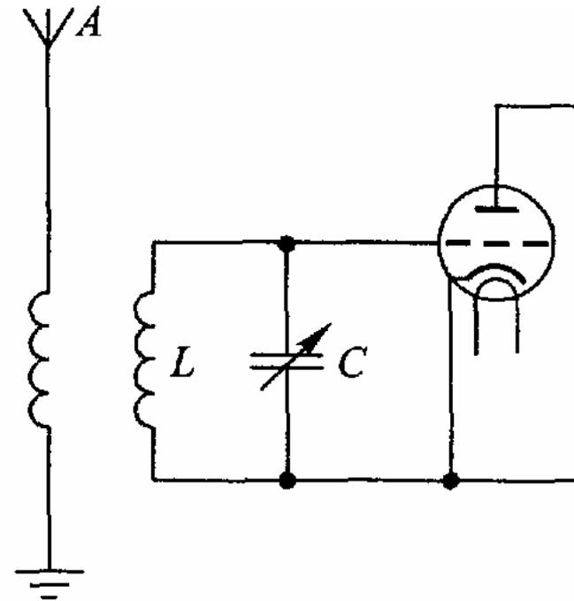
Входной контур радиоприемника (схематически)
